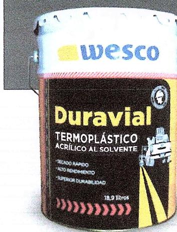
Excelente compatibilidad con esferas de vidrio que mejoran la visibilidad nocturna. Se recomienda la proporción de 1 litro de pintura aplicada con 1 kilo de micro esferas tipo "DROP ON".
